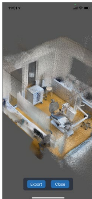
Abb. 6: Site scape – LiDAR Scanner 3D : Selbst bei einer Scanzeit von unter 30 Sekunden ...
